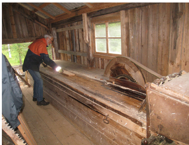
Foto 8. Färdigkantad bräda matas ut.
